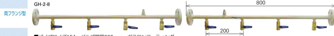
■パイプサイズ15A、バルブ間隔200mm、ガスロンコーティング
